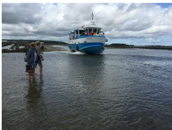
Het amfibievoertuig, bij laagwater rijden, bij hoogwater varen
