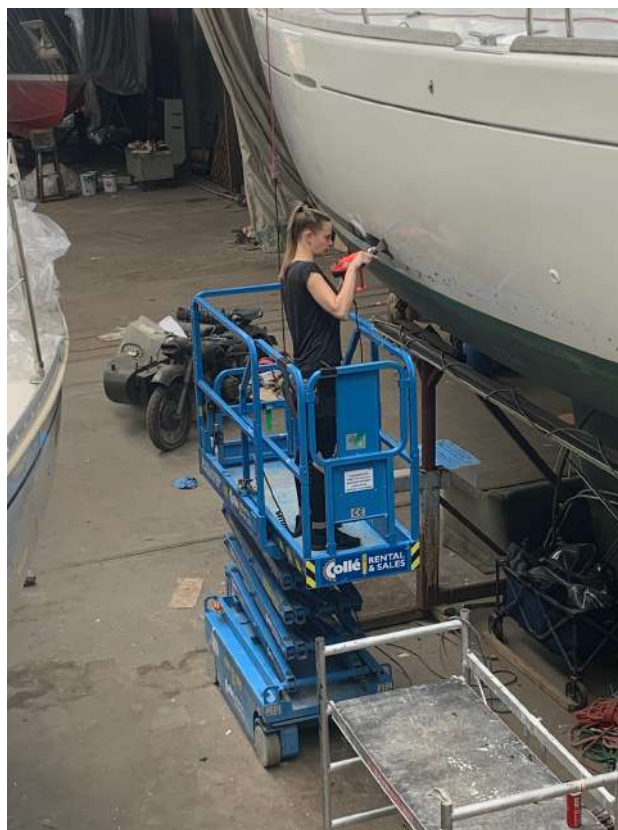
Met de hoogwerker eerst de striping verwijderen
