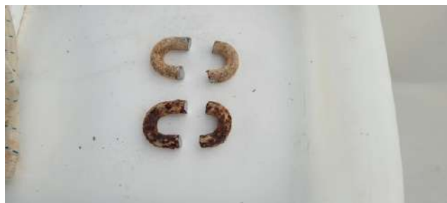
De met een haakse slijper verwijderde schakels
