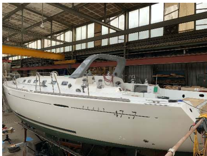
De beugel is voor de 3 e keer in een kleur geschilderd. Even kijken naar het resultaat en dan wordt ook de buiskap ingemeten. De beugel gaat er wel weer af, want er komt nog een laatste laklaag op.
