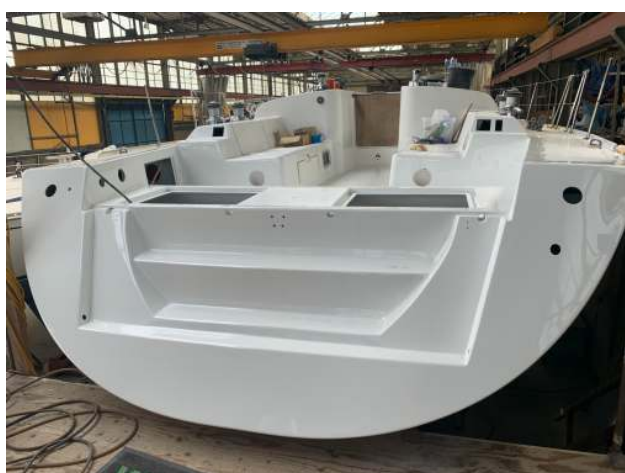
Laatste aflaklaag. Eindelijk een strak resultaat.
