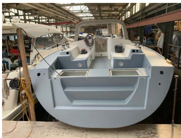
Laatste laag primer zit erop.
