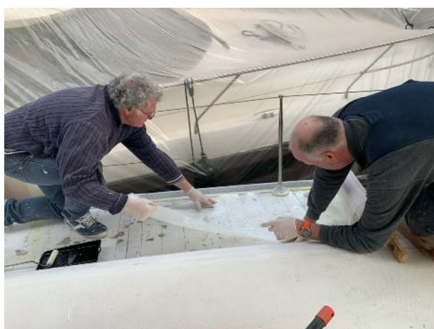
Aanbrengen epoxy, 2 lagen glasvezel en 1 laag peelply
