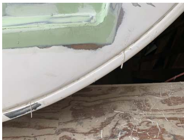
Het verwijderen van de kitrand bij de spiegel
